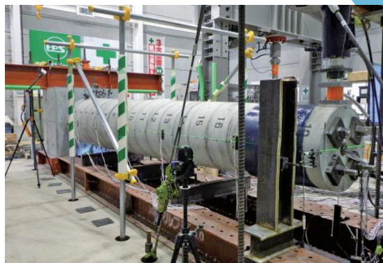
写真-1 曲げ載荷試験状況
