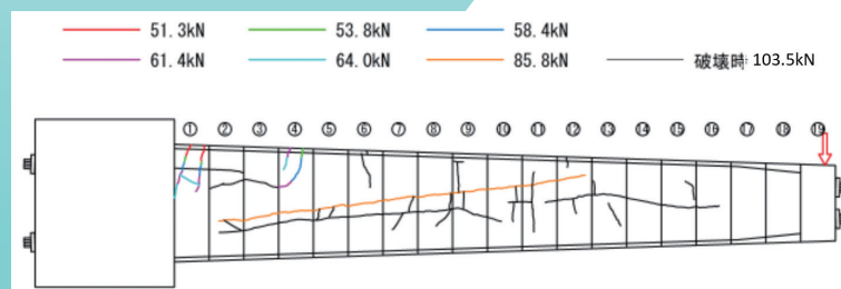
図-3 ひび割れ図
